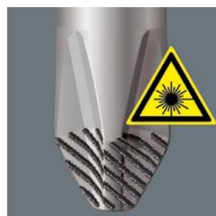
Mittels eng fokussiertem Laserlicht wird eine scharfkantige Oberflächenstruktur erzeugt. Die Laserbehandlung bewirkt eine Härte der Spuren von bis zu 1000 HV 0,3. Wera Lasertip kratzt sich im Schraubkopf fest und verhindert das Herausrutschen aus dem Schraubkopf.
