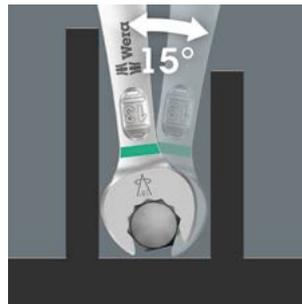
Der Ringmaulschlüssel Joker 6003 mit seiner besonderen Maulgeometrie – eine um 7,5° geschwenkte Maulseite und die Doppelsechskantgeometrie – verdoppelt die Ansetzmöglichkeiten bei wiederholter 180°-Drehung des Schlüssels um die Längsachse. Muttern bzw. Schraubenköpfe können
