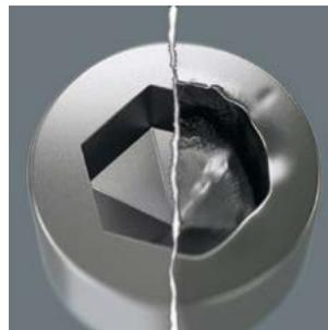
Innensechskantschrauben haben das Problem, schnell „rundgedreht“ zu werden. Grund ist die Einwirkung der scharfen Kante des Werkzeugs auf die Innenfläche des Schraubenkopfs. Der allmähliche Abnutzungsprozess führt schließlich zum „Runddrehen“. Wera Hex-Plus
