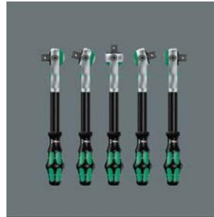
Der Knarrenkopf ist frei schwenkbar und kann durch den beidseitig angebrachten Schiebesehalter in jeder Fixierungsposition verriegelt werden. Problemloses Arbeiten mit großem Handfreiraum ist selbst in sehr engen oder schwer zu erreichenden Einbausituationen möglich. Die definierte Fixierung bei 0°, 15° und 90° nach links und rechts garantiert sicheres
