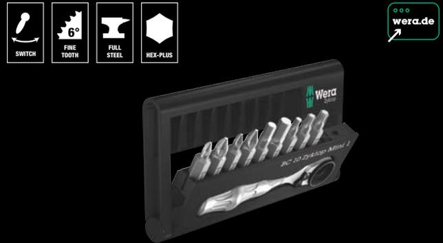
9 Bits; zähhart, für den universellen Einsatz. 1 Wera Bit-Ratsche Zyklop Mini 1, gesenkgeschmiedete Vollstahlausführung; geeignet für die Aufnahme von Bits mit 1/4"-Außensechskantantrieb nach DIN ISO 1173-C 6,3 und E 6,3 und Wera Anschluss-Reihen 1 und 4; über Adaptierung mit Wera Adapter 870/1 ist auch der Einsatz von 1/4"-Nüssen möglich
