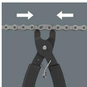
La pince à attache rapide facilite l'ouverture de la chaîne pour le nettoyage ou le remplacement de maillons.
