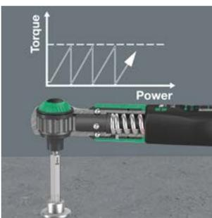
La clé dynamométrique Safe-Torque A 2 est équipée d'un mécanisme de débrayage. L'outil ne peut pas dépasser le couple réglé de sorte que l'application d'un couple trop élevé est exclue.
