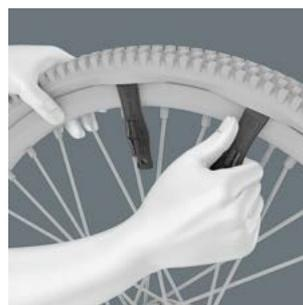
Les démonte-pneus en plastique renforcé de fibre de verre permettent de retirer les pneus de la jante, sans endommager la jante. Avec un des démonte-pneus, faire lever avec la jante et l'accrocher dans un rayon et détacher le pneu avec le deuxième démonte-pneu.
