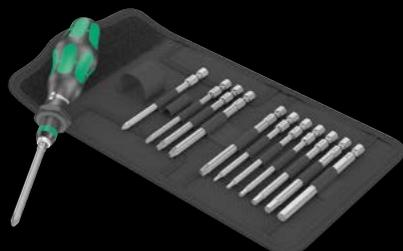
13 pièces, sous pochette pliante ; 1 porte-embouts 816 R Kraftform avec mandrin à serrage rapide Rapidaptor, convenant pour embouts à emmanchement hexagonal 1/4" selon DIN ISO 1173-C 6,3 et E 6,3 ainsi que des séries 1 et 4 Wera; 12 embouts de 89 mm de long, extra-rigide, usage universel
