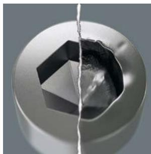
Le problème des vis à six pans creux tient à la finesse des surfaces d'appui sur lesquelles s'opère la transmission de la force depuis l'outil. Résultat : la tête de vis peut être endommagée. Les outils Hex-Plus possèdent des surfaces d'appui plus larges qui empêchent ce problème. Le couple transmis
