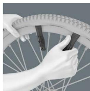
Les démonte-pneus en plastique renforcé de fibre de verre permettent de retirer les pneus de la jante, sans endommager la jante. Avec un des démonte-pneus, faire levier avec la jante et l'accrocher dans un rayon et détacher le pneu avec le deuxième démonte-pneu.
