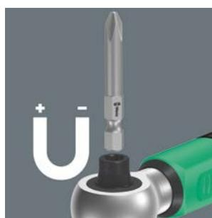
La clé dynamométrique Safe-Torque A 2 présente une admission d'embout 1/4" avec puissant aimant permanent et convient aux embouts à emmanchement hexagonal 1/4" selon DIN ISO 1173-C 6,3 et E 6,3 et aux séries Wera 1 et 4.
