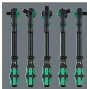
ラチェットヘッドは首を180°自由に回転でき、ホイールスイッチで回転方向の変更が可能。限られた狭いスペースで作業するとき、首の左右に0°、15°、90°の動作角度で固定できるので、滑ることなく安全に作業できます。
