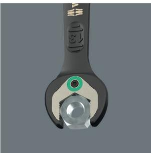
ジョーカーの保持機能により、ボルトとナットをスパナ側で保持でき、狭いスペースでの作業を可能にします。開口部にある取替可の金属プレートがボルトやナットを支え、作業中なくす心配がありません。ボルトやナットの位置が取れたら、他に工具を使わず
