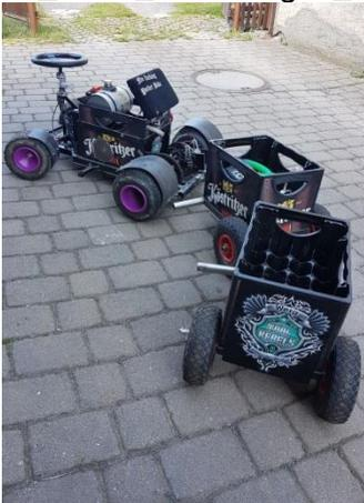
Este tren tractor tan original lleva un emblema tipo “Tool Rebel” inmenso en la parte trasera de su segundo remolque. El motor muy pequeño se encuentra en una caja de cerveza, y un mini-barril de cerveza sirve de depósito de combustible.
