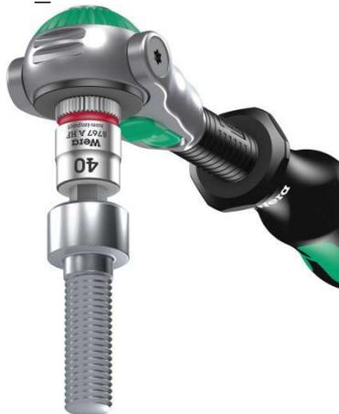
Nelle nuove bussole per viti ad esagono cavo la funzione di ritegno è costituita da una speciale meccanica a sfera. Dopo l'avvitamento l'utensile si sgancia senza problemi.
