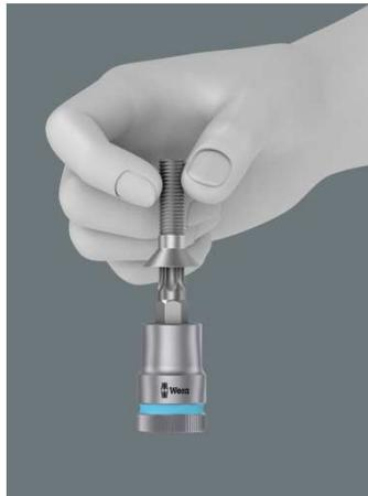
I nuovi inserti-bussola da 3/8" della Wera dispongono di una innovativa funzione di ritegno, che trattiene le viti saldamente all'utensile. Una speciale geometria p.es. per il profilo TORX® produce una forza di serraggio tra utensile e vite.
