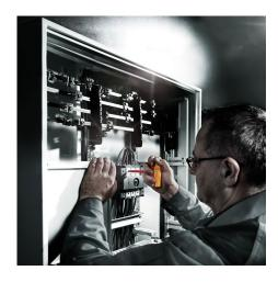
I nuovi indicatori di coppia con impugnatura a T con coppia di serraggio fissa di 4 oppure 5 Nm, nella versione isolata VDE collaudati fino a 1.000 Volt.
