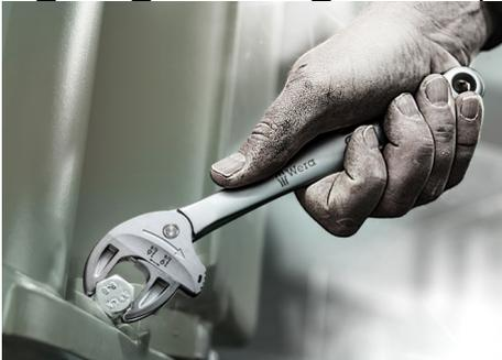
La llave de boca autoajustable Joker 6004 es capaz de ajustar el tamaño necesario al posicionarla en el hexágono del tornillo o de la tuerca, de manera continua y automática. Gracias a la utilización de los prismas angulares de la parte delantera de la boca, es posible realizar un ángulo de retorno de tan solo 30° que resulta muy práctico para trabajos en espacios sumamente estrechos.
