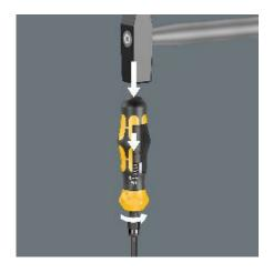
Der Hammerschlagimpuls wird bei zugeschalteter Schlagschraubfunktion in eine Drehbewegung mit einem Lösemoment von bis zu 25 Nm umgesetzt.
