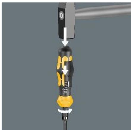
Cuando la función de destornillador de golpe está activada el impulso del golpe del martillo se convierte en un movimiento giratorio con un par de desapriete de hasta 25 Nm.
