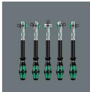
Der Knarrenkopf der Zyklop Speed Knarre ist frei schwenkbar und kann durch den beidseitig angebrachten Schiebeschalter in jeder Fixierungsposition verriegelt werden. Problemloses Arbeiten mit großem Handfreiraum ist selbst in sehr engen oder schwer zu erreichenden Einbausituationen möglich. Die definierte Fixierung bei 0°, 15° und 90° nach links und rechts garantiert sicheres Arbeiten ohne Verrutschen des Knarrenkopfes.
