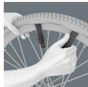
Mit den glasfaserverstärkten Reifenhebern aus Kunststoff lassen sich die Reifen sicher von der Felge hebeln, ohne die Felge zu beschädigen. Mit dem einen Reifenheber von der Felge abheben, in einer Speiche einhaken und mit dem zweiten Reifenheber den Reifen abziehen. Die beiden
