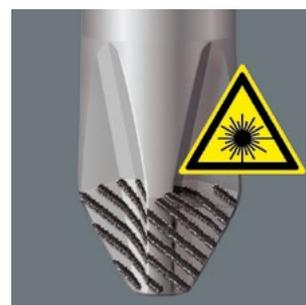
Mittels eng fokussiertem Laserlicht wird eine scharfkantige Oberflächenstruktur erzeugt. Die Laserbehandlung bewirkt eine Härte der Spuren von bis zu 1000 HV 0,3. Wera Lasertip krallt sich im Schraubenkopf fest und verhindert das Herausrutschen aus dem Schraubenkopf.
