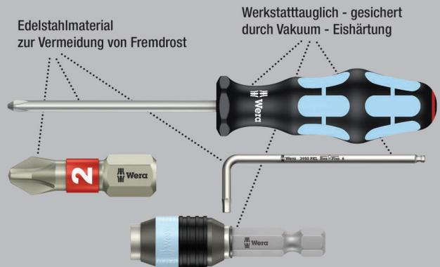
Wera Edelstahl Werkzeuge werden aus Edelstahl gefertigt, wodurch der unansehnliche Fremdrost vermieden wird. Mit Torsionszone: Bei Torsion-Bits werden Drehmomentspitzen in der Torsionszone abgedeckt. Vorzeitiger Verschleiß wird vermieden, die Lebensdauer des Bits erhöht. 1/4"-Sechskant, passend für Halter nach DIN ISO 1173-D 6,3.
