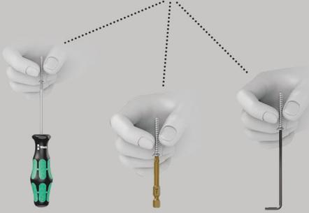
Les outils TORX® HF (HF = fonction de retenue) conçus par Wera se distinguent par une optimisation géométrique du profil TORX® originel. La force de blocage résultant des pressions superficielles s'exerçant entre la pointe d'entraînement et le profil de la vis permet un maintien sûr de cette dernière sur l'outil ! Hexagonal 1/4", convient pour porte-embouts répondant à la norme DIN ISO 1173-F 6,3.
