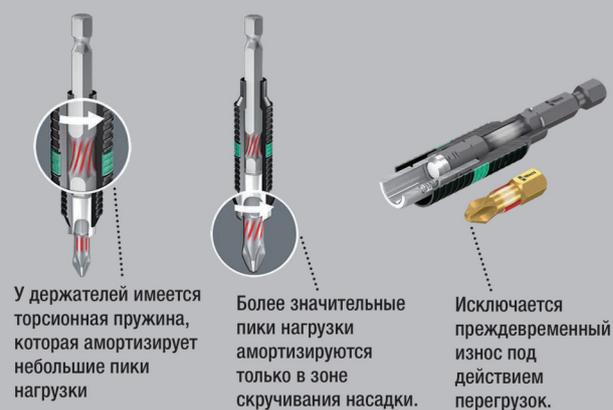
У держателей имеется торсионная пружина, которая амортизирует небольшие пики нагрузки
