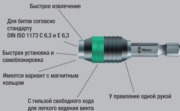
Универсальный держатель для битов с шестигранным хвостовиком 1/4" по стандарту DIN ISO 1173-C 6,3 и E 6,3 (ISO 1173). Из специальной стали, что исключает распространение контактной ржавчины. Технология Rapidaptor позволяет ставить биты даже без использования гильзы. Извлечение битов осуществляется простым сдвигом гильзы вперед - моментальная смена битов даже одной рукой. Шестигранный хвостовик 1/4", подходит для шуруповертов с патроном по стандарту DIN ISO 1173-F 6,3.
