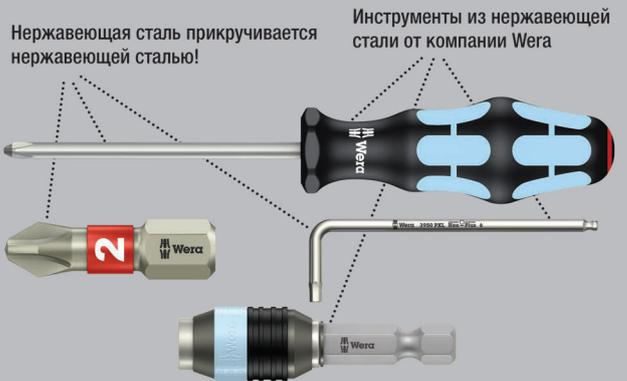
Высококачественные шлицевые биты из специальной стали. Инструменты Wera Edelstahl изготавливаются из специальной стали, что исключает неприятное распространение контактной ржавчины. Шестигранный хвостовик 1/4", подходит для держателя по стандарту DIN ISO 1173-F 6,3.
