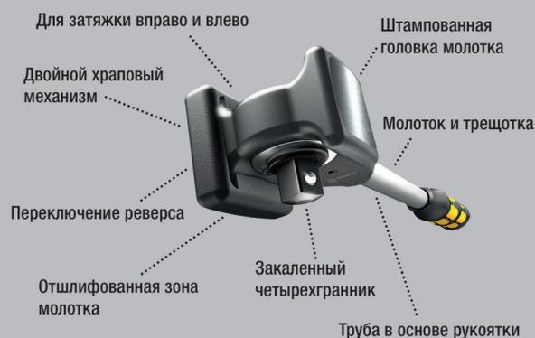
Трещотка, которой разрешено пользоваться как молотком. Трещотка Koloss – это сверхпрочная трещотка с реверсом и с минимальной нагрузочной способностью 600 Нм. Двойное зубчатое зацепление и минимальный угол возврата 6° обеспечивают быстрое и точное завинчивание даже в узком пространстве.
