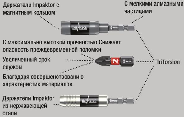
Технология Impaktor обеспечивает срок службы инструментов, заметно превышающий средние показатели даже с учетом жестких условий их применения. Повышенное сопротивление трению за счёт шероховатого покрытия из алмазных частиц предотвращает выскользывание наконечника из винта. Особенно подходят для работы с предлагаемыми на рынке ударными винтовёртами. Шестигранный хвостовик 1/4", подходит для держателя по стандарту DIN ISO 1173-F 6,3.
