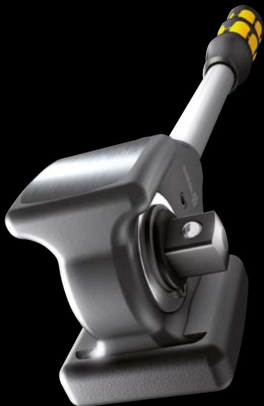
Mecanismo de trinquete doble. Gracias al mecanismo de trinquete doble, los 30 dientes robustos producen el efecto de 60 dientes finos con un ángulo de retorno de 6°.
