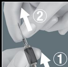
Zum Bitwechsel einfach die Hülse nach vorne schieben. Das Werkzeug wird dadurch entriegelt, der Bit kann problemlos entnommen werden!
