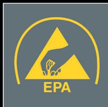
Die Wera-Produkte der Serie ESD erfüllen die Europa-Norm DIN EN 61340-5-1. Der elektrische Oberflächenwiderstand des Wera-ESD-Materials ist  $< 10^9$  Ohm. Bei der Einrichtung eines speziellen ESD-Schutzbereichs wird eine statische Aufladung sicher zum Erdpotential abgeleitet.
