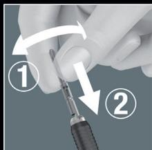
**Blitzschneller Bit-Wechsel:** Bits mit 4 mm Halbmoon-Antrieb (Reihe 9): Bit drehend in den Kombibithalter einführen, bis die beiden „Halbmond-Profile“ ineinander greifen, und den Bit bis auf Anschlag schieben. Der Bit ist sicher verriegelt.
