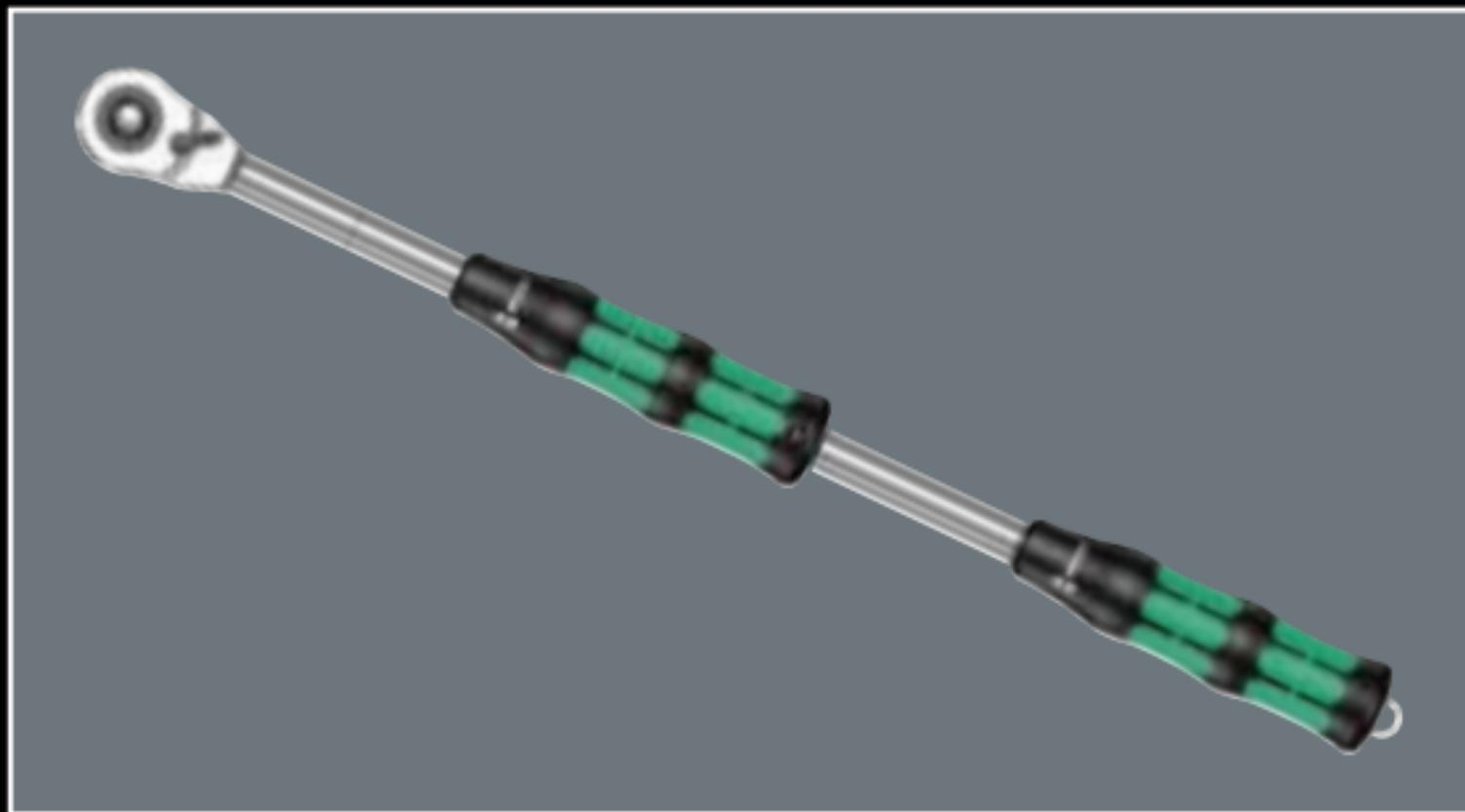
**Verlängerung zur Drehmomenterhöhung einstecken und um 90° drehen bis der federnde Stift der Verlängerung in die Querbohrung des Knarrenrohres einrastet.**
