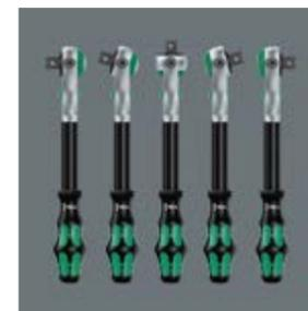
Der Knarrenkopf ist frei schwenkbar und kann durch den beidseitig angebrachten Schiebesehalter in jeder Fixierungsposition verriegelt werden. Problemloses Arbeiten mit großem Handfreiraum ist selbst in sehr engen Einbausituationen möglich.
