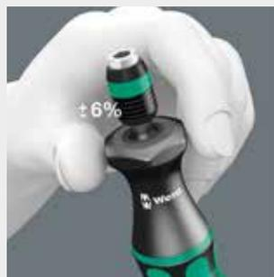
Ces tournevis dynamométriques sont livrés avec une valeur de couple pré-réglée, ce qui est idéal pour toutes les applications qui nécessitent constamment le même couple. Couple pré-réglé de 0,3 Nm à 4,0 Nm (ajustable de 0,3 Nm à 8,8 Nm), trois manches différents, précision de mesure de ± 6 %, échange éclair des embouts grâce à l'admission d'embouts Rapidaptor.
