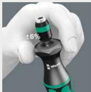
Questi giravite dinamometrici vengono forniti con una coppia preimpostata. Ciò risulta essere ideale per tutti i lavori che richiedono sempre la stessa coppia: coppia preimpostata da 0,3 Nm a 4,0 Nm (regolabile da 0,3 Nm a 8,8 Nm), tre impugnature diverse, precisione ± 6 %, cambio degli inserti ultrarapido grazie al porta-inserti con tecnologia Rapidaptor.
