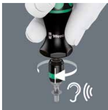
Duidelijk hoor- en voelbaar kliksignaal bij het bereiken van het draaimoment.
