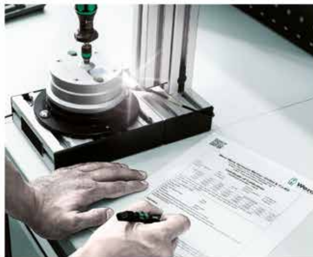
Wszystkie narzędzia dynamometryczne Wera są produkowane, regulowane, kalibrowane i certyfikowane zgodnie z surowymi wymaganiami jakościowymi. Na życzenie klienta Wera może również wydać certyfikat kalibracji zgodnie z wytycznymi Niemieckiej Jednostki Notyfikującej DAkkS we współpracy z akredytowanym laboratorium.
