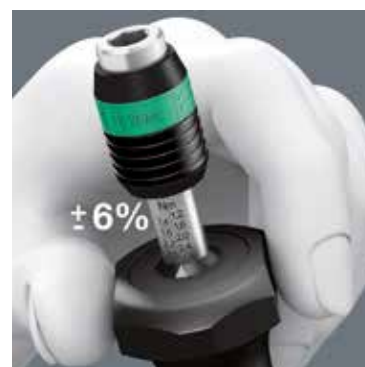
Dokładność \pm 6\% (artykuł 1430: \pm 10\% ) zgodnie z normą DIN EN ISO 6789. Wyraźne słyszalne i wyczuwalne zwolnienie po osiągnięciu żądanego momentu obrotowego.
