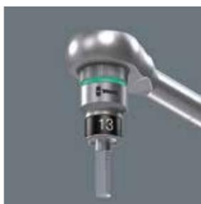
Il bloccaggio nella chiave della vite con testa esagonale, avviene tramite due sfere ed una guaina elastica ad alta resistenza. Quest'ultima viene protetta efficacemente da un collare d'acciaio contro lesioni meccaniche. Particolarmente d'aiuto in spazi di lavoro difficilmente raggiungibili, laddove
