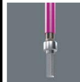
Le viti ad esagono cavo vengono trattenute sulla chiave a L tramite una sfera a molla. Particolarmente utile negli spazi difficilmente raggiungibili nei quali non è possibile usare la seconda mano per mantenere la vite.
