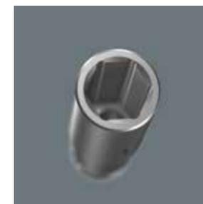
Il profilo esagonale rende possibile la trasmissione di elevate forze e sollecita in modo minore il bordo del dado e/o della testa della vite rispetto ad un profilo poligonale. Cricchetti con meccanismo di dentatura fine, grazie al loro ridotto angolo di ripresa, rendono superfluo l'impiego di un profilo poligonale, anche in spazi ristretti.
