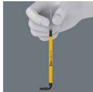
En situaciones de montaje estrechas y difíciles, (por ejemplo en un motor), no es posible sostener el tornillo con la mano, de manera segura, en el destornillador. Por esto, frecuentemente pasa que el tornillo se escapa y se pierde. La consecuencia puede ser que se desperdicie mucho tiempo al
