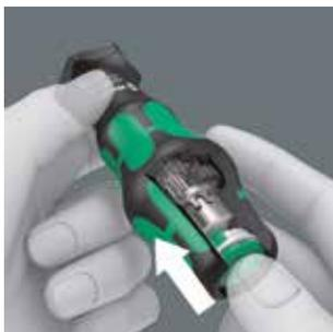
En caso de que se precise, la función de "Turbo" se puede activar simplemente pulsado un botón. La desconexión se recomienda en el caso de pares de giro ascendentes, o cuando se trata de realizar un ajuste fino, o cuando se quiere realizar un apriete o desapriete final de un tornillo mediante un alto par de giro.
