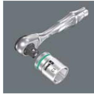
Le mini-cliquet Zyklop Mini 3 a un angle de reprise de 6° grâce à ses 60 dents.
