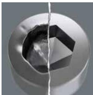
Le problème des vis à six pans creux tient à la minceur des surfaces d'appui sur lesquelles s'opère la transmission de la force depuis l'outil. Résultat : la tête de vis peut être endommagée. Les outils Hex-Plus possèdent des surfaces d'appui plus larges qui empêchent ce problème. Avec la possibilité,
