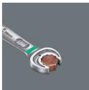
L'ingénieuse géométrie dodécagonale de Joker engendre une liaison géométrique intime avec la vis ou l'écrou – une liaison qui tient ! Et la plaque interchangeable en métal trempé située dans la fourche de Joker « enserre » littéralement la vis de ses pointes extrêmement dures. Deux atouts permettant
