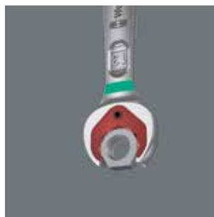
Con la funzione di sostegno del Joker l'operatore riesce ad avvicinare le viti e i dadi in maniera sicura, direttamente fino al punto di avvvitamento. In questo modo è estremamente facile "imboccare" la filettatura. Le viti o i dadi non cadono più e non si deve più perdere tempo prezioso per la loro ricerca.
