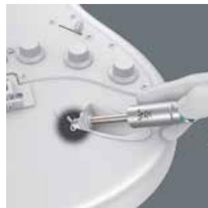
Grazie al jack di ingresso contenuto nel set, la presa di uscita si può posizionare in maniera sicura al montaggio e allo smontaggio. I dadi esagonali all'esterno vengono allentati o stretti per mezzo della bussola Zyklop.
