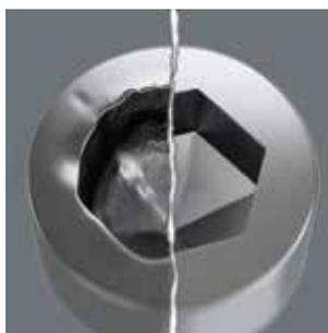
Le viti a esagono cavo sono problematiche perché la loro superficie d'appoggio, che trasmette la forza dall'utensile alla vite, è molto ridotta. Ciò favorisce la deformazione della testa della vite. Gli utensili Hex-Plus dispongono di una superficie d'appoggio maggiore che riducono quindi questo problema. Buono a sapersi: gli utensili Hex-Plus sono adatti per ogni vite a esagono cavo convenzionale!
