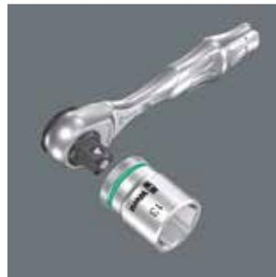
Il cricchetto Zyklop Mini 3 è l'utensile ideale per avvitare in spazi ristretti. La dentatura fine (60 denti) permette un angolo di richiamo molto ridotto di soli 6°; la rotella zigrinata consente avvitamanti rapidi, anche dove non c'è spazio per la rotazione.
