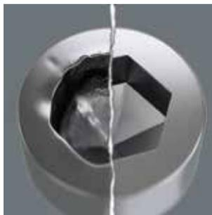
Le viti a esagono cavo sono problematiche perché la loro superficie d'appoggio, che trasmette la forza dall'utensile alla vite, è molto ridotta. Ciò favorisce la deformazione della testa della vite. Gli utensili Hex-Plus dispongono di una superficie d'appoggio maggiore che riducono quindi questo
