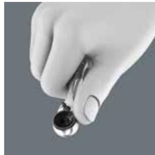
Ручка-трещотка для битов Zyklop Mini 1 служит для особенно быстрой работы даже в ограниченном пространстве. Биты присоединяются напрямую. С адаптером Wera 870/1 (переход с шестигранника 1/4" на квадрат 1/4") можно использовать также торцовые головки 1/4".
