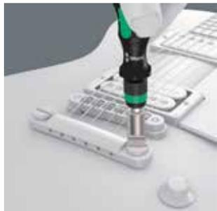
Бит 3800/1 (1,8 x 12 x 41 мм) из нержавеющей стали идеально подходит для регулировки винтов струнодержателя. Нержавеющая сталь предотвращает образование контактной ржавчины на деталях из нержавеющей стали.
