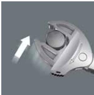
За счёт автоматического и плавного зажима параллельно перемещающихся губок рождковый ключ Joker 6004 подходит для всех размеров в соответствующем диапазоне. Ключ сам и без регулировки выбирает нужный размер при накидывании на гайку или винт.
