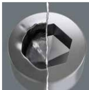
Проблема винтов с внутренним шестигранником Hex-Plus заключается в том, что этот профиль быстро скругляется. Причина этого связана с воздействием острых граней инструмента на внутреннюю поверхность головки винта. Процесс постепенного износа в итоге
