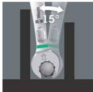
Комбинированный гаечный ключ Joker 6003 с особой формой рожковой части - наклоном на 7,5° и профилем в виде двойного шестигранника - увеличивает вдвое возможности для накидывания ключа при повторных поворотах ключа в процессе завинчивания на 180° относительно продольной оси. Гайка или головка винта захватывается через каждые 15°. Практически Joker 6003 сам находит соответствующее положение после каждого перекидывания.
