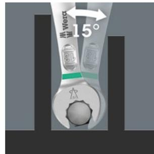
Der Ringmaulschlüssel Joker 6003 mit seiner besonderen Maulgeometrie – eine um 7,5° geschwenkte Maulseite und die Doppelsechskantgeometrie – verdoppelt die Ansetzmöglichkeiten bei wiederholter 180°-Drehung des Schlüssels um die Längsachse. Muttern bzw. Schraubenköpfe
