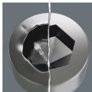
Le problème des vis à six pans creux tient à la minceur des surfaces d'appui sur lesquelles s'opère la transmission de force depuis l'outil. Résultat : la tête de vis peut être détruite. Les outils Hex-Plus possèdent des surfaces d'appui plus larges qui empêchent les têtes de vis de s'arrondir. Bon à
