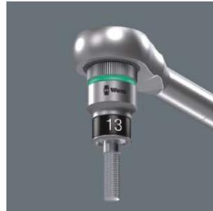
Le maintien de la vis hexagonale dans la douille à carré est assuré par deux billes élastiques et une gaine thermo-rétractable haute résistance à élasticité permanente. Celle-ci est protégée contre les endommagements mécaniques par une collerette d'acier située à l'avant. Particulièrement
