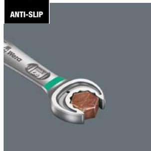
L'ingénieuse géométrie dodécagonale de Joker engendre une liaison géométrique intime avec la vis ou l'écrou – une liaison qui tient ! Et la plaque interchangeable en métal trempé située dans la fourche de Joker « enserre » littéralement la vis de ses pointes extrêmement dures. Deux
