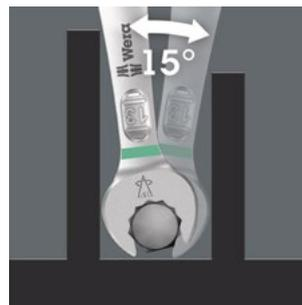
La llave de anillo y boca Joker 6003 con su geometría de boca muy especial – el lado de la boca está doblado en un ángulo de 7,5°, así como la geometría de doble hexágono – duplica las posibilidades de posicionamiento durante las repetidas vueltas de la llave en 180° por el eje longitudinal.
