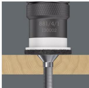
Il porta-inserti 81/4/1 consente l'annegamento a filo uniforme di viti nelle tavole di legno nella costruzione di terrazze. La profondità di avvitamento può essere regolata a seconda del fabbisogno. Ciò permette di annegare le viti non troppo in profondità.
