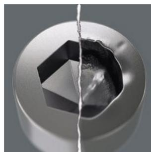
Il problema delle viti a cava esagonale è la veloce stonatura della cava. Il motivo è dovuto all'azione dello spigolo vivo sulla superficie interna della testa della vite. Il continuo processo di usura o deformazione giunge poi allo stonamento. Gli utensili Wera Hex-Plus dispongono di maggiori superfici
