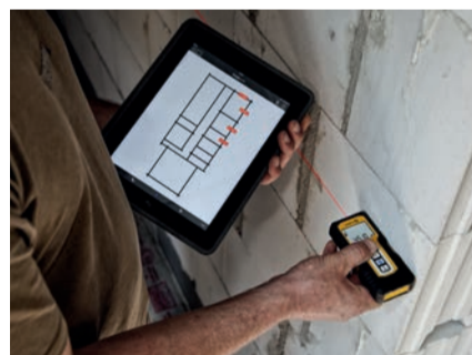
Ermittelte Messdaten lassen sich kabellos auf Smartphone oder Tablet übertragen – dank Bluetooth® Smart-Technologie.
