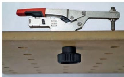
**BESSEY Schnellspanner der großen Baureihe und mittlerer Bohrung in der Grundplatte können jetzt auch auf Multifunktions-tischen wie z. B. Festool MFT oder Sortimo WorkMo zum Einsatz kommen.**
